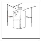
Buzdolabının üst boşluğu 10 cm'den fazla olmalı, ısı dağılımını kolaylaştırmak için buzdolabı her iki tarafta 10 cm'den fazla serbest mesafeye sahip bir duvara yerleştirilmeli ve cihazların arkası 7,5 cm'yi aşmayan bir serbest mesafeye sahip bir duvara verleştirilmelidir
