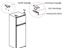
Dondurucu bölmesi kapısının orta menteşesini, soğutucu kapısının manşon borusunu ve diğer taraftaki delik kapaklarını çıkarın.
